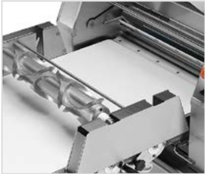
OPTIONAL La stazione di taglio a due principi evita che la pasta si attacchi allo stampo. The double seat cutting station avoids the dough to stick in the moulds.
