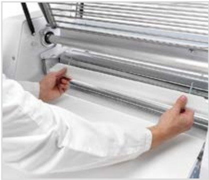
Raschiatore facile da rimuovere per una veloce pulizia. Scraper simple to remove for a quick cleaning.
